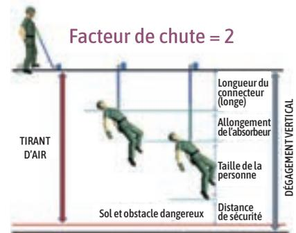
Le point d'ancrage se trouve aux pieds de l'opérateur ou en-dessous, permettant une chute équivalente à deux fois la longueur de la longe avant le déploiement de l'absorbeur d'énergie pour arrêter la chute.
