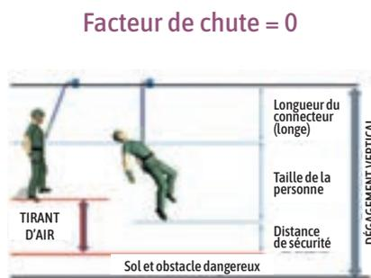
L'ancrage se trouve au-dessus de la tête et la longe est tendue entre le point d'ancrage et l'opérateur. Le tirant d'air est réduit comme est indiqué, avec une distance de chute minimale.
