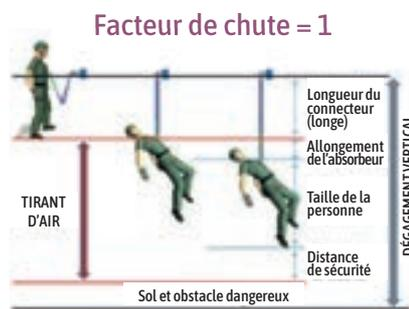
Le point d'ancrage se trouve au niveau du point d'attache du harnais, permettant une chute équivalente à la longueur de la longe avant le déploiement de l'absorbeur d'énergie pour arrêter la chute.
